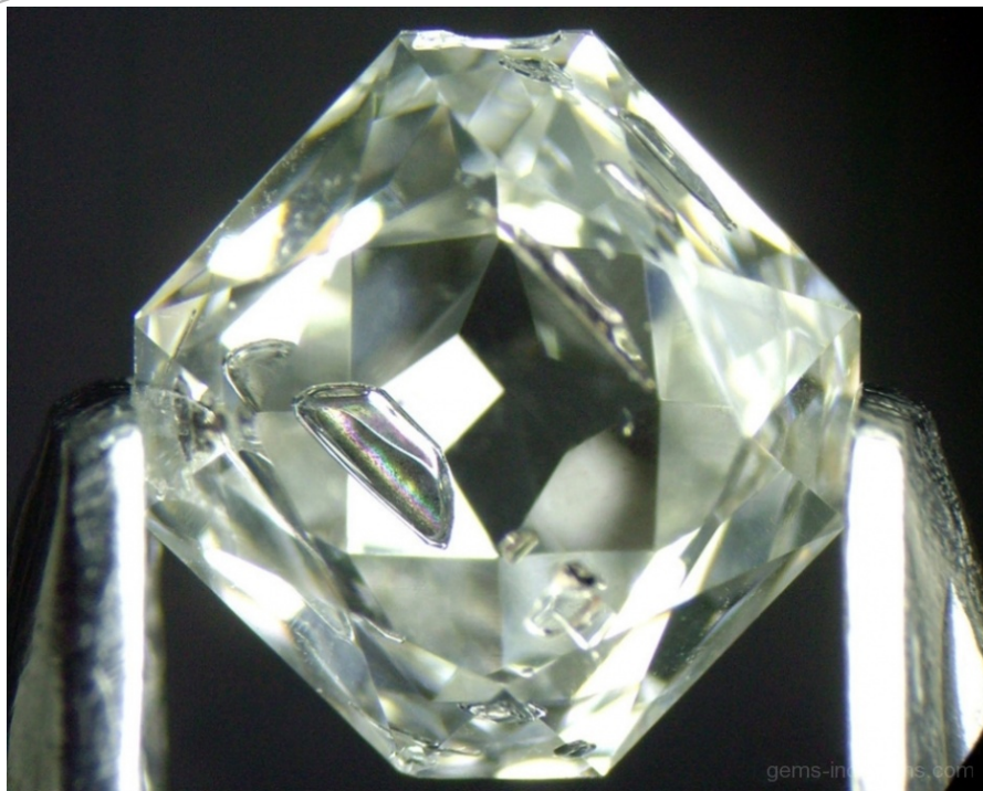
Включения металла в синтетическом алмазе, выращенном методом HPHT. Поле зрения 5 мм.
